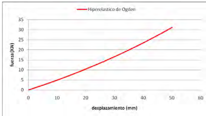
Figura 6: Curva fuerza – desplazamiento del modelo numérico para una deformación controlada de 50mm.
