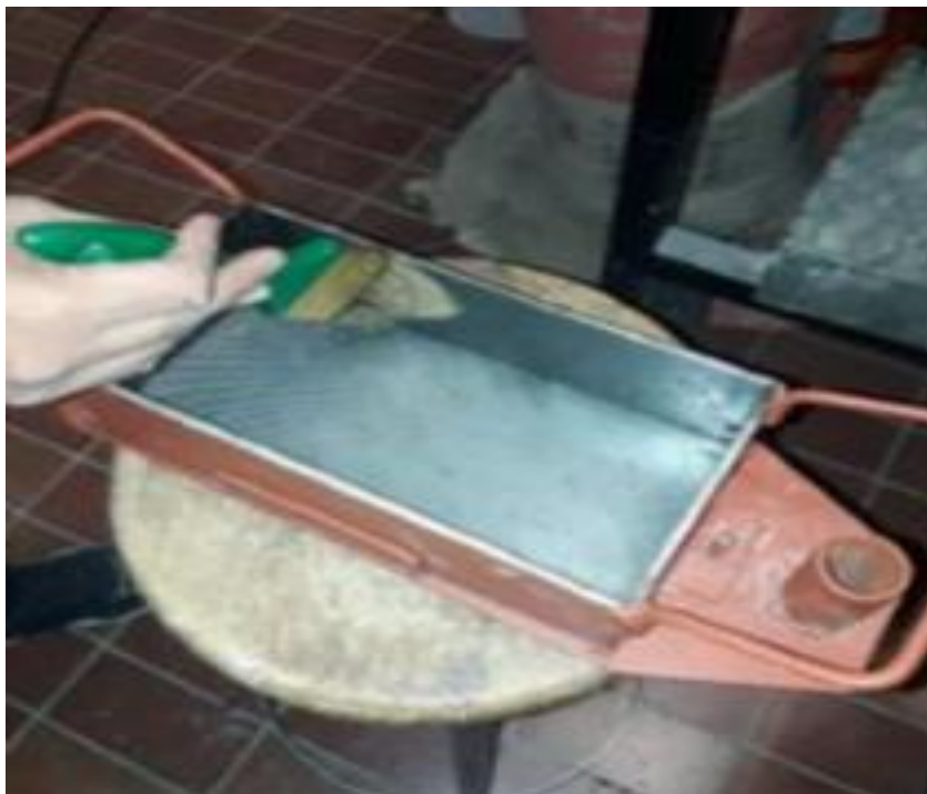
Figura 3 Colocación y distribución de la mezcla en los moldes
