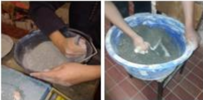
Figura 2 Mezcla de las partículas de PET con el Cemento Portland y los áridos
